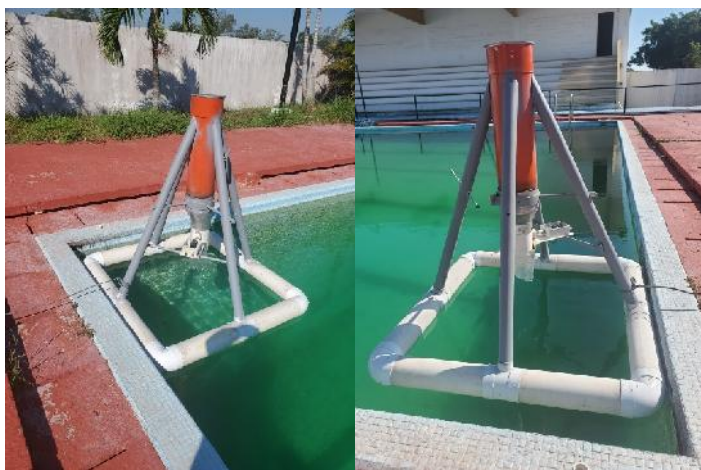
Imagen 12.- vistas isométricas del sistema de flotación.
