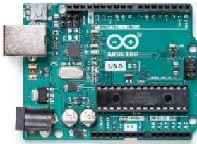
Imagen 3.- Placa de desarrollo Arduino ATmega328P.
