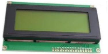
Imagen 5.- Pantalla LCD (Liquid Cristal Display) 4 x 20.
