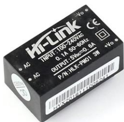
Figura 4. Fuente de alimentación HLK-PM01.
