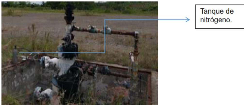
Figura 3. Conexión del tanque de nitrógeno para realizar disparos sobre la TP. (Fuente Tetra).
