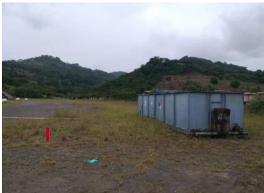
Figura 8 Presa metálica de medición para almacenado de hidrocarburo (Fuente propia, propiedad compañía outsourcing).
